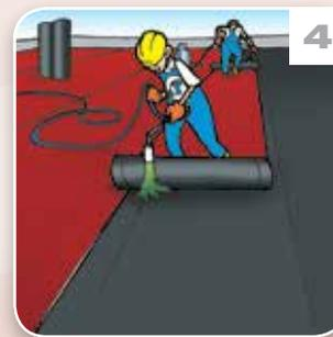
**NB:** Se posato rispettando le raccomandazioni sopra indicate, la resistenza del pacchetto (PLURA THERMO AD - PRATIKO P+V) all'azione depressiva del vento sarà non inferiore a 7,0 kPa (700 kg/m<sup>2</sup>). (Rapporto Ufficiale di Prova "Report BDA 0256-L-02")
